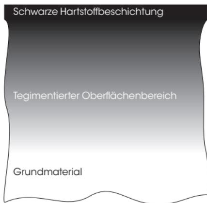
Schematischer Aufbau unserer Hartstoffschicht auf einer mit der TEGIMENT-Technologie gehärteten Oberfläche.
